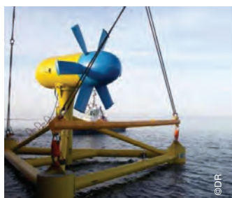
Hydrolienne à flux axial ; prototype sur l'île d'Ouessant.
